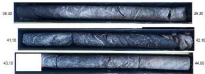
Figure 74 Photographie des sondages utilisés pour la réalisation des éprouvettes.
