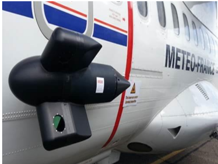
Figure 1-2 : Sonde ALIDS installée sur l'ATR-42 de chez SAFIRE.
