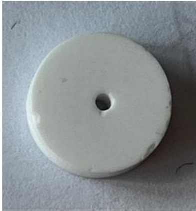
Figure 88 : Exemple d'un échantillon préparé pour l'évaluation de la ténacité comportant un trou central de diamètre d'environ 1 mm après traitement thermique à 1575 °C
