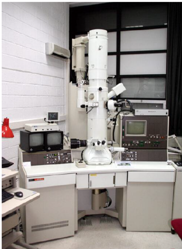
FIGURE 2.8 – Appareil MET utilisé pour la caractérisation des poudres [6].
