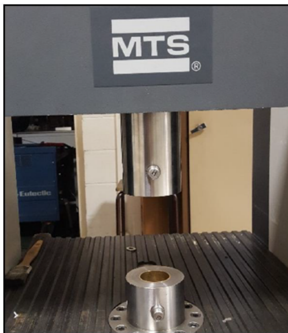
FIGURE 2.12 – Photographie de la presse utilisée pour les essais de traction /compression in-situ utilisé au LSPM.
