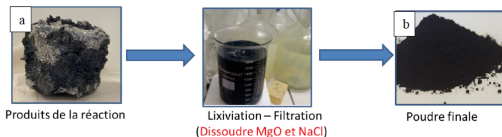
FIGURE 2.3 – Produit de la réaction de synthèse (a) – poudre finale obtenue après lixiviation(b).
