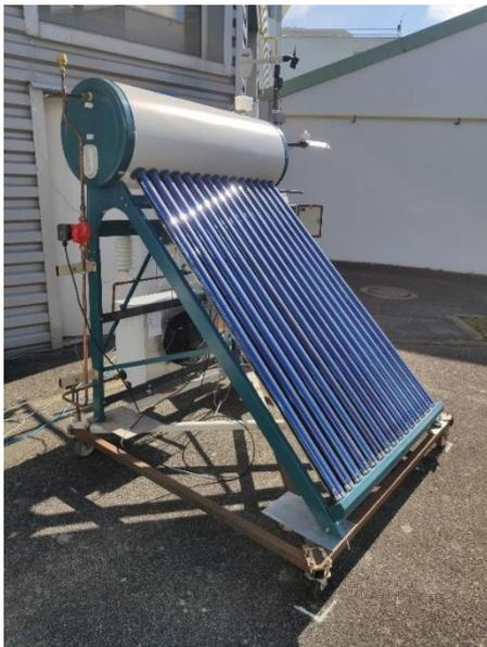
Figure II-3: Photographie du chauffe-eau solaire
