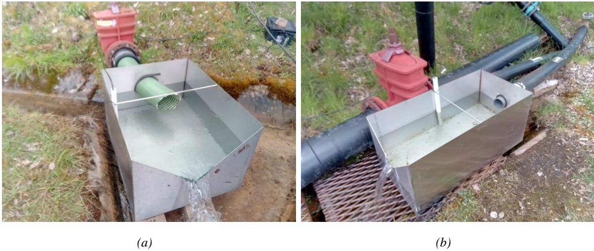
Figure 4.7 : Seuil triangulaire et sonde de pression au point (a) DESC1 et (b) V105.
