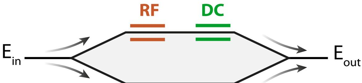
FIGURE 4.7 – Principe d'un modulateur électro-optique de Mach-Zehnder.
