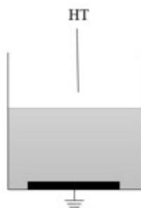
Figure I-11 : Exemple de configuration expérimentale typique pour produire des plasmas en phase gazeuse au-dessus d'un liquide (Bruggeman & Leys, 2009).
