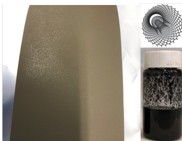
Figure 65 : Photographies des enductions, des mélanges CNT – solvant après dispersion et représentations schématiques des CNT pour (a) les SWNT, (b) les DWNT et (c) les MWNT.
