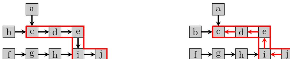
FIGURE 1.4 – À gauche : un arbre d'épluchage  $T$  avec  $j$  comme cellule enracinée. Le chemin  $\tau$  entre les cellules  $c$  et  $j$  est entouré en rouge. À droite : l'arbre  $\bar{T}$  résultant après avoir inversé les arêtes de  $\tau$ .
