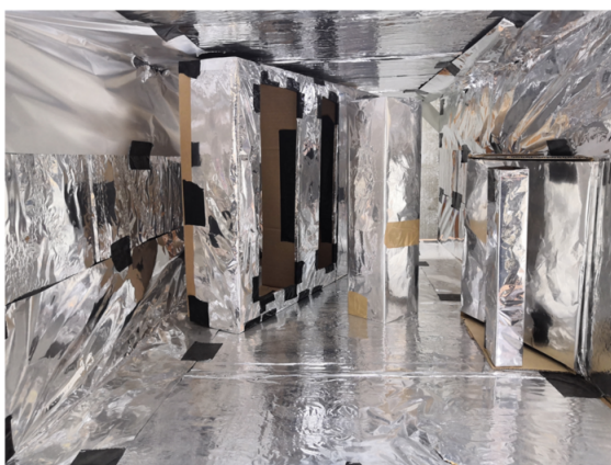
FIGURE II.8: Le canal 2 : à droite, vue latérale de la boîte réverbérante de dimension 132\text{ cm} \times 70\text{ cm} \times 50\text{ cm} , à gauche, vue de l'intérieur du canal 1.
