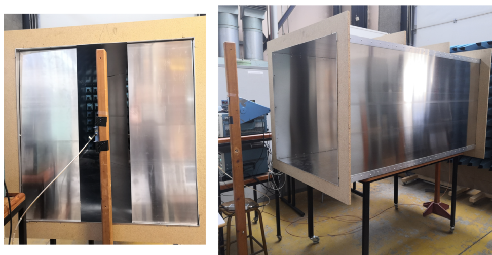
FIGURE II.7: Le canal 1 : à droite, vue latérale de la boîte réverbérante de dimension 100 cm × 100 cm × 200 cm, à gauche, vue de l'intérieur de la variante du canal 1.
