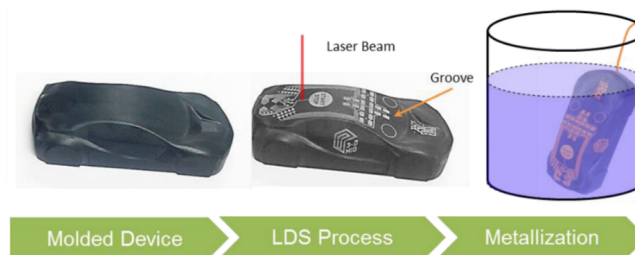
Figure 2.8 : Etapes de fabrication d'un objet par structuration laser directe.
