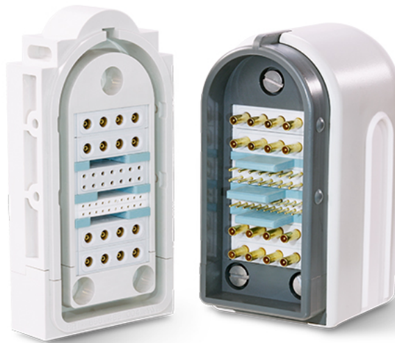
Figure 2.20 : Exemple d'un boîtier de connexion utilisé sur les IRM cliniques commerciales. La partie de gauche est liée à l'imageur tandis que la partie de droite est reliée au réseau d'antennes. On peut voir les connecteurs coaxiaux mâles dorés sur quatre rangées de 4 sur le boîtier de droite. Les petites pins de connexion visibles au milieu de ce boîtiers assurent la transmission de signaux continus (DC) qui commandent les circuits de découplage actif.
