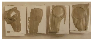
Figure 3.21 : Photographie du film PVDF recouvert de masques et de laque d'argent.
