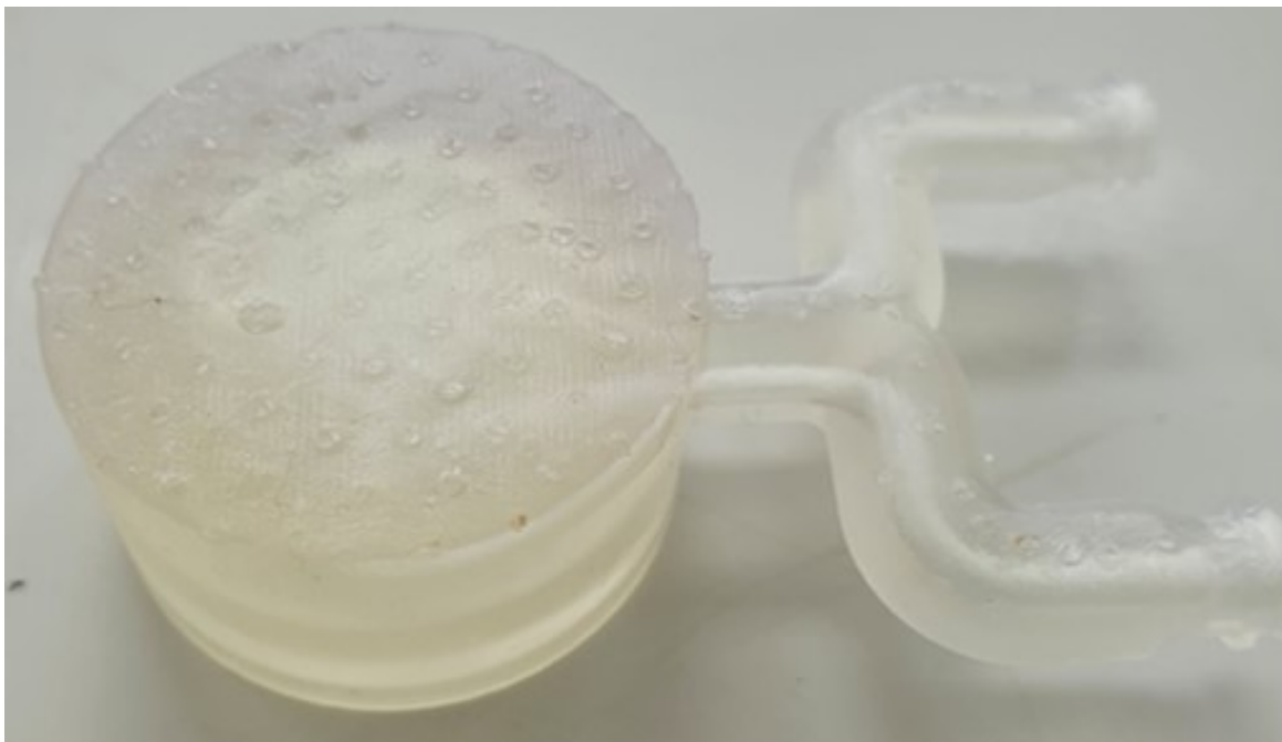
Figure 2.34 : Exemple de la surface inférieure de la chambre de culture sur laquelle on voit les restes de supports mécaniques nécessaires à l'impression. Des imperfections sont visibles à la fois sur le dessous de la chambre interne de culture mais aussi sur le dessous du circuit microfluidique (sur la droite de la photo).
