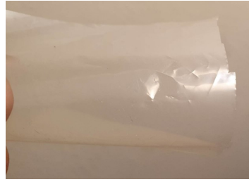
Figure 3.19 : Photographie d'un carré de film de PVDF prêt à être métallisé.
