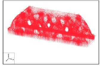
(c) Topologie et orientation optimisées d'un pont 3D: tracé de la direction la plus rigide de l'anisotropie locale
