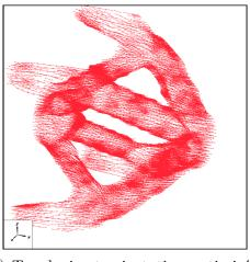
(b) Topologie et orientation optimisées d'un inverseur de déplacement 3D: tracé de la direction la plus raide de l'anisotropie locale
