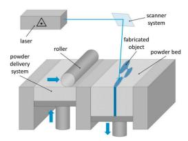
Figure 2: Fabrication additive utilisant la fusion sélective des métaux (une technologie de fusion de lit de poudre), figure de [110] (une version modifié de l'original qui est issue de [65])
