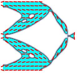
(b) Topologie et orientation optimisées d'un inverseur de déplacement 2D: tracé de la direction la plus rigide de l'anisotropie locale
