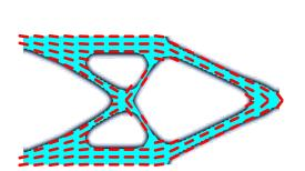
(a) Topologie et orientation optimisées d'un porte-à-faux 2D: tracé de la direction la plus rigide de l'anisotropie locale
