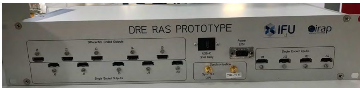
FIGURE 5.3 : Face avant du prototype du DRE RAS. La programmation du FPGA se fait avec la prise USB. Les prises SMB CLK_OUT et Sync_Out servent à synchroniser, respectivement, la master clock et la frame rate avec le DEMUX. Les signaux d’ouverture et fermeture des FAS se font par les prises HDMI. Celles-ci sont divisées en deux groupes : les signaux différentiels ou asymétriques.
