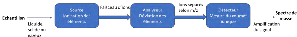
Figure 2-3 : Schéma du principe de fonctionnement d'un spectromètre de masse
