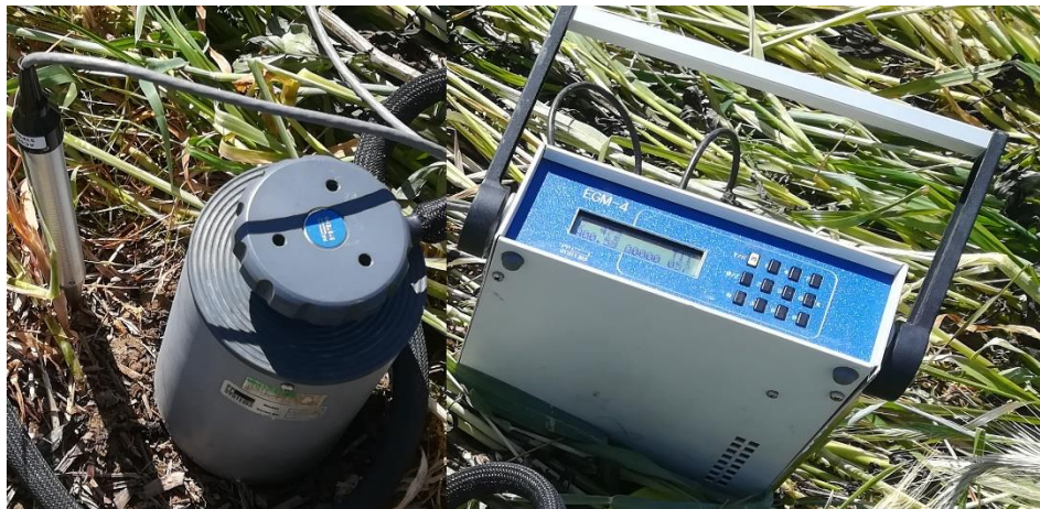
Figure 2-1 : Chambre de respiration et analyseur de gaz à infrarouge EGM-4 (PP System, Amesbury, USA), photographie : N.L. Breil.
