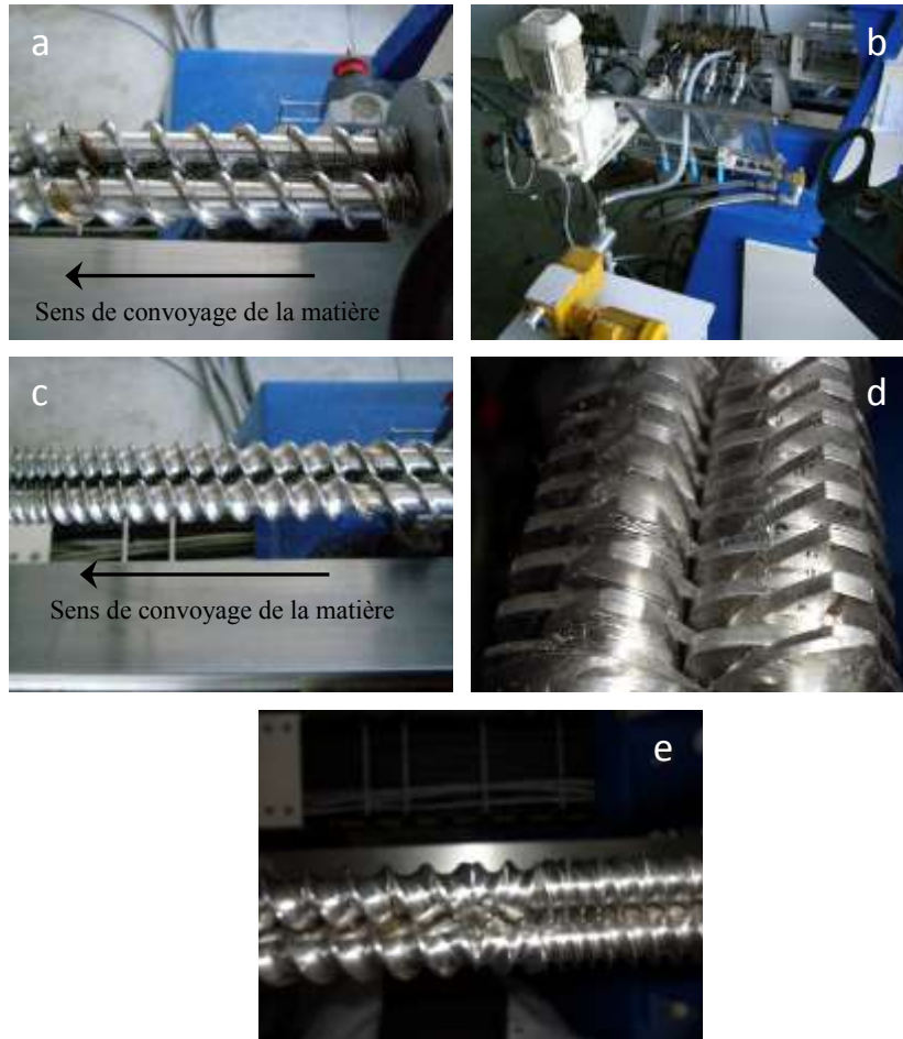
Figure II-14 : Photos illustratives de la configuration de l'extrudeur baxis.
