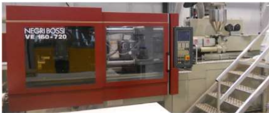
Figure II-18 : Photo presse à injecter Negri Bossi VE 160-720.
