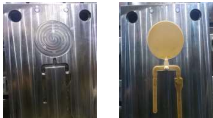
Figure II-19 : Photo empreintes moule vide (à gauche) et rempli (à droite).
