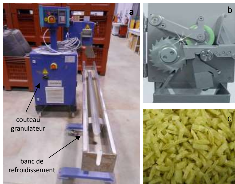
Figure II-17 : Couple couteau granulateur/banc de refroidissement (a), vue en coupe de la tête du couteau granulateur (b) et granulés obtenus après découpage au couteau granulateur (c).
