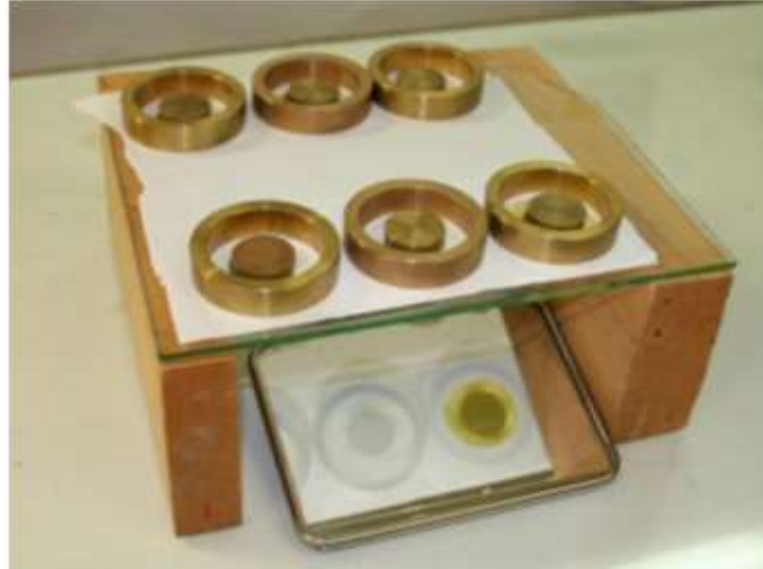
Figure VI-10 : Appareillage pour la détermination de l'imperméabilité aux graisses.
