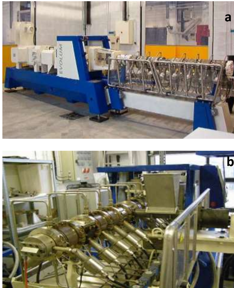
Figure VI-11 : Photos des extrudeurs Evolum HT53 (a) et Evolum HT25 (b).
