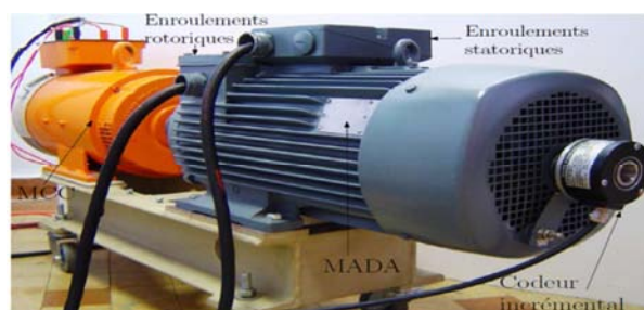
Figure 5-2 : Photo du banc moteur disponible au laboratoire LAPLACE.
