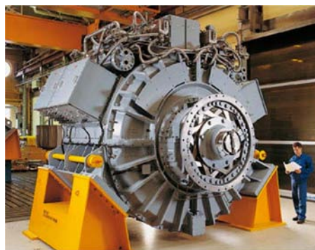
Figure 1-9 : Moteur à aimants permanents d'un sous-marin (Source Siemens)
