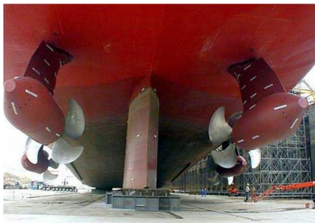
Figure 1-5 : POD sur le Queenmarray [Source Converteam]
