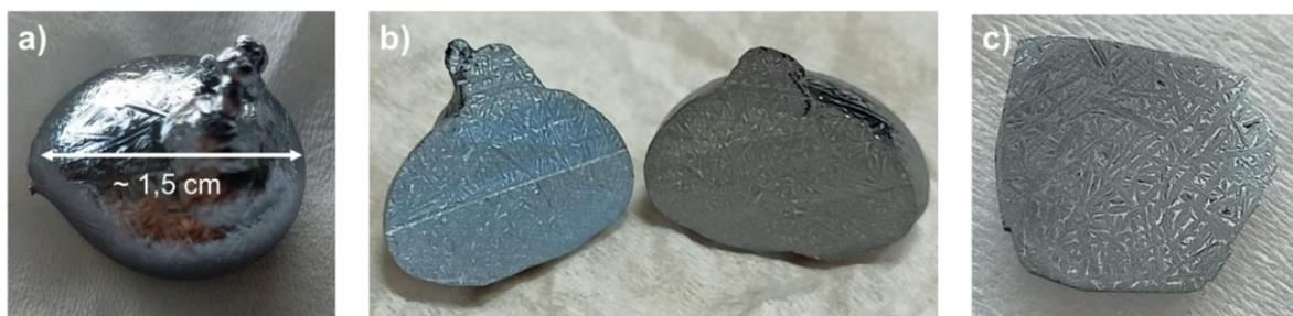
**Figure 2.16** Photographies d'un lingot Al-Si après a) fusion au four à arc, b) découpe en deux à la scie à fil et c) polissage d'une tranche (ici avec 20 %atAl). Les zones claires allongées dans l'alliage, visibles en c), correspondent aux micro-cristaux de Si typiquement formés lors du refroidissement d'un liquide Al-Si homogène.
