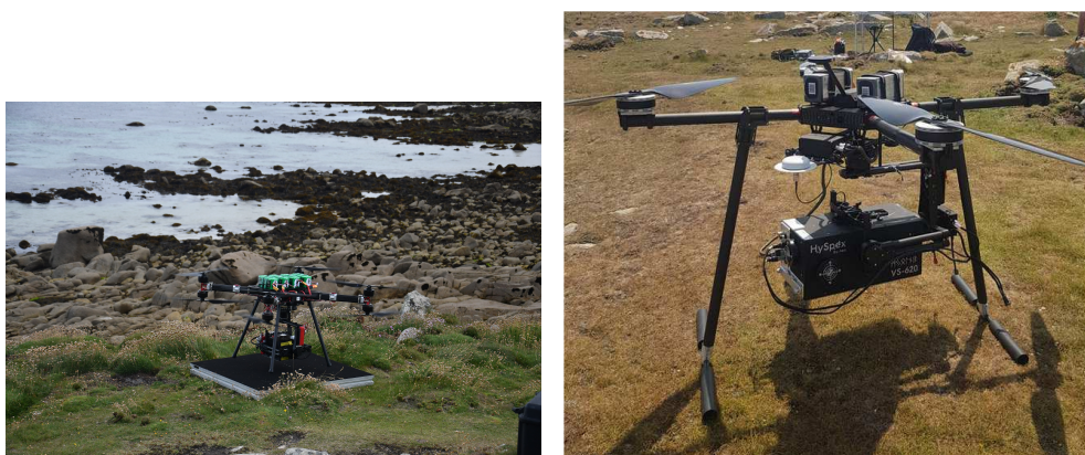
(a) Drone équipé du capteur Mjolnir V-1240 (b) Drone équipé du capteur Mjolnir VS-620
