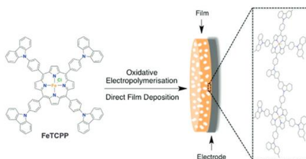
Figure 26 : Electropolymérisation d'une porphyrine de fer via oxydation de fonctions carbazoles. Reproduit avec copyright © 2023, The Royal Society of Chemistry. [153]
