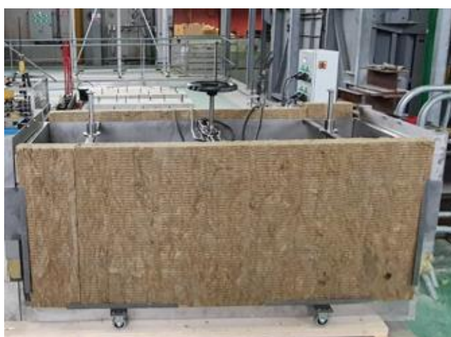
Figure 91 : Chauffage au portique radiant
