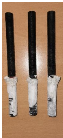
Figure 83 : Ruptures par perte d'adhérence des chevilles chimiques
