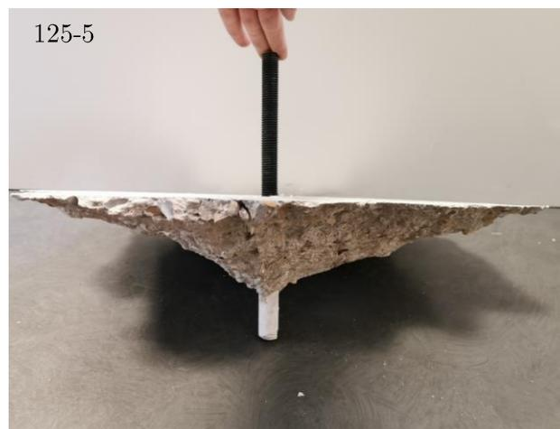
Figure 85 : Rupture mixte par cône béton et perte d'adhérence
