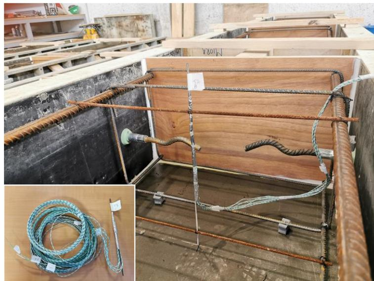
Figure 79 : Echelle de thermocouples
