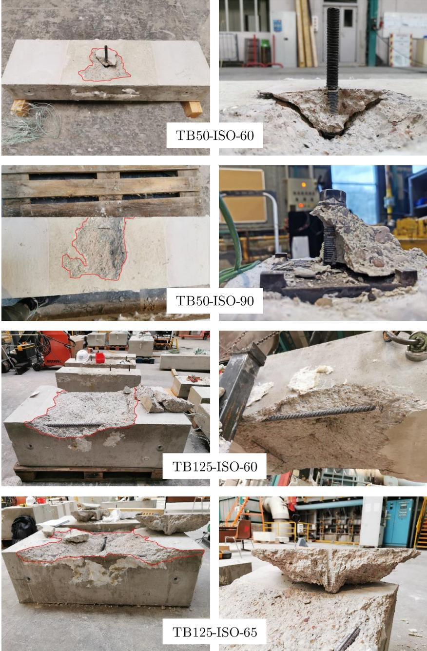
Figure 94 : Profils de rupture des boulons à tête sous conditions de feu standard
