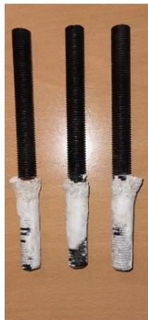
Figure 83 : Ruptures par perte d'adhérence des chevilles chimiques
