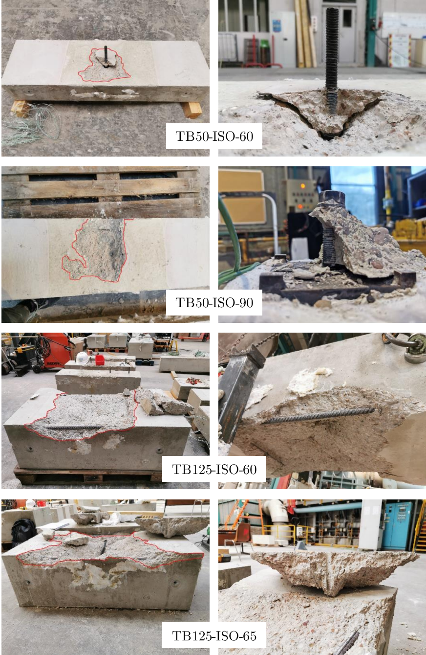
Figure 94 : Profils de rupture des boulons à tête sous conditions de feu standard
