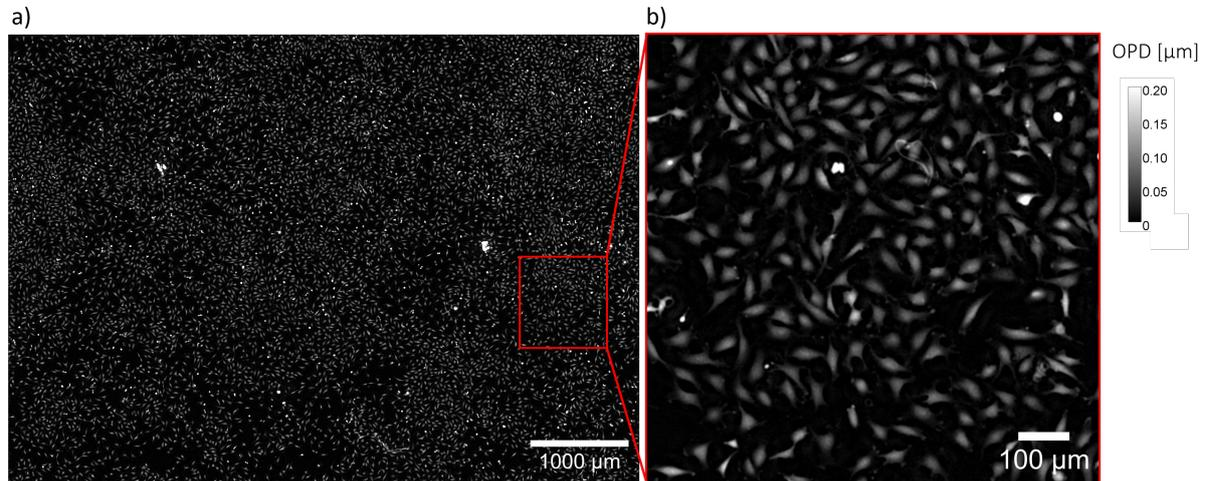
**Figure IV.2 :** (a) Image de microscopie sans lentille reconstruite complète et (b) extrait d'une zone de 30 mm<sup>2</sup>. Chaque point blanc sur l'image est une cellule
