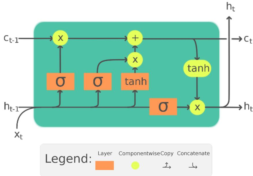
Figure II.4 : Schéma d'une cellule LSTM [Che18]
