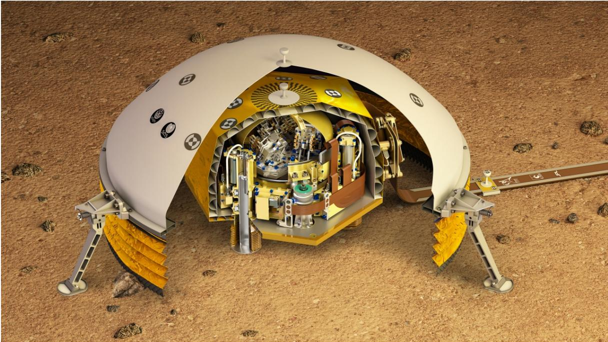
**Figure I.4 :** Le sismomètre SEIS : de l'extérieur vers le centre, on distingue les boucliers thermique et éolien, puis l'enceinte de confinement sphérique qui protège les pendules du sismomètre au centre (©IPGP/David Ducros [Duc18])
