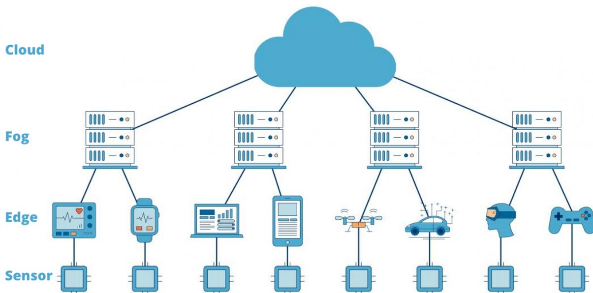
**Figure I.1 :** Illustration des différents niveaux de calculs pour l'internet des objets allant du calcul dans le nuage, puissant mais éloigné physiquement des utilisateurs, aux capteurs intelligents proches du capteur, mais avec de faibles ressources [Say19]
