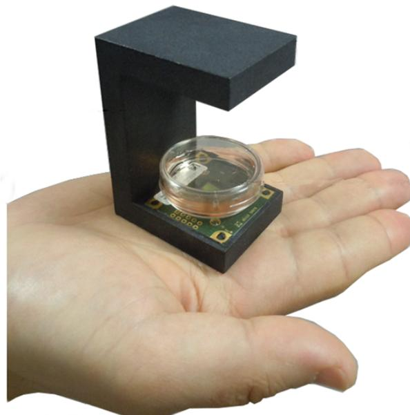
**Figure IV.1** : Dispositif de microscopie sans lentille
