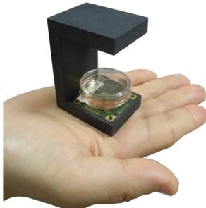
**Figure I.2 :** Dispositif de microscopie sans lentille
