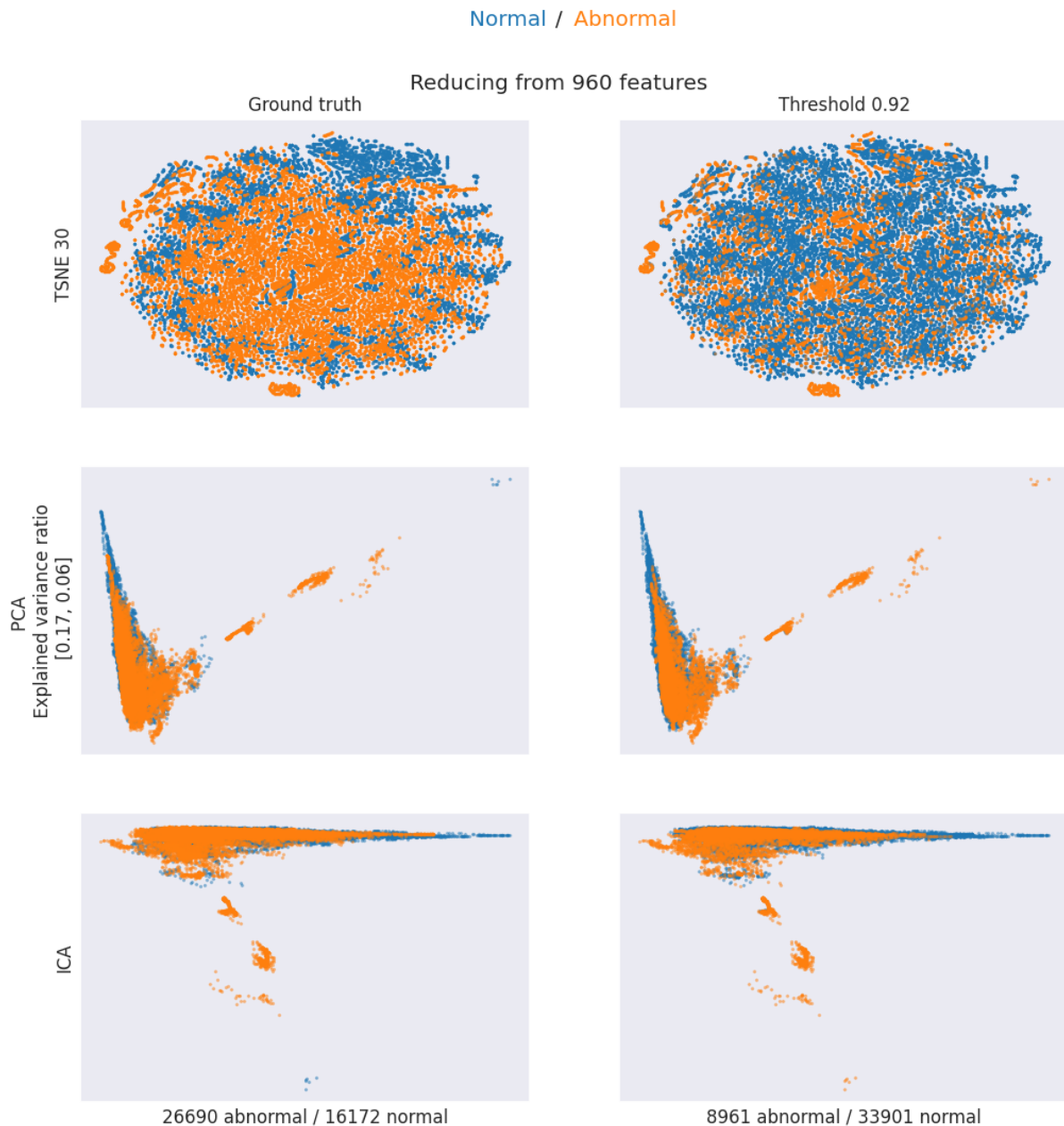
Figure IV.16 : Projection dans 3 espaces différents des features (extraites au niveau du goulot d'étranglement) des données \mathcal{C} (normales) en bleu et \mathcal{C}' (anormales) en orange. On constate que les données normales ne sont pas séparables des données anormales (elles se superposent). La représentation ne projette donc pas les données de classes différentes dans des endroits différents de l'espace latent
