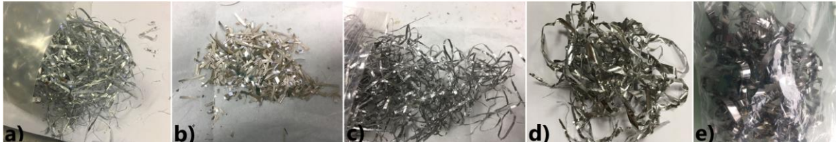
Figure II-3 : Photographie des différents rubans issus de la trempe sur roue d'alliage de \text{Al}_{83}\text{Cu}_{17} (a) ; \text{Mg}_{40}\text{Cu}_{60} (b) ; \text{Mn}_{56}\text{Cu}_{44} (c) ; \text{Mn}_{49}\text{Cu}_{51} (d) ; \text{Mn}_{37}\text{Cu}_{63} (e)
