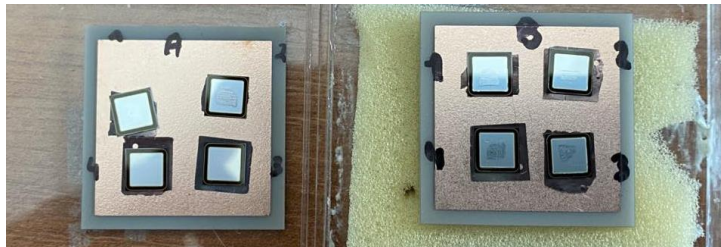
Figure IV-10 : Photographie des assemblages A et B réalisés dans les conditions de thermocompression de référence, à savoir, 300°C, 20 MPa et 30 min.
