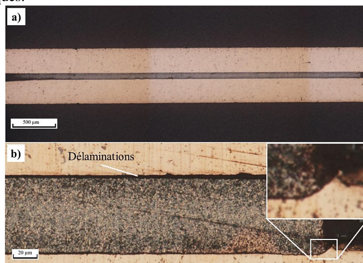
Figure IV-8 : Observation au microscope optique d'une coupe d'un assemblage DBC/Lames Cu nanoporeux/DBC réalisé à 300^\circ C , pendant 30 min et sous 20 MPa (a) ; zoom sur le bord droit du joint (b)
