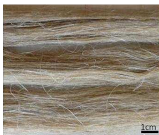
Fig. IV-3 : Mèches de lin déposées manuellement (UD Main Lin)
