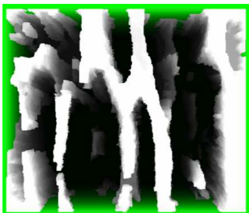
Fig. IV-12 : Reconstruction 3D des pores de l'échantillon UD Tissé Lin
