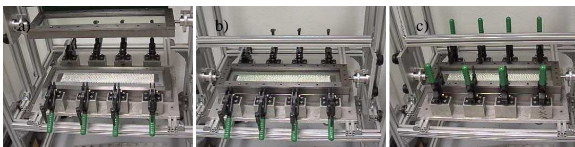
Fig. IV-23 : Moule a) ouvert, b) fermé et c) comprimé
