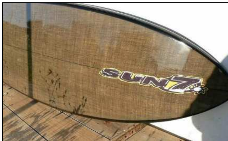
Fig. I-21 : Planche de surf en composite à fibres de lin
