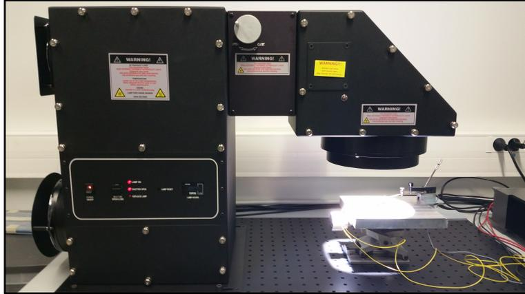
FIGURE 2.13 – Photographie du simulateur solaire de l'IES.
