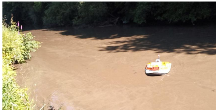
Figure 15 : Le drone aquatique immobilisé par les dépôts de sédiment affleurant à la surface de l'eau sur le site de Signy
