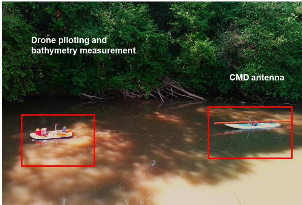
Figure 18 : Antenne CMD guidée par une drone aquatique sur le site de Signy. Une distance supérieure à la distance de détection de l'antenne CMD (6 m) est maintenue entre le drone et l'antenne pour éviter que les champs magnétiques des moteurs du drone perturbent le champ magnétique mesuré par l'antenne.
