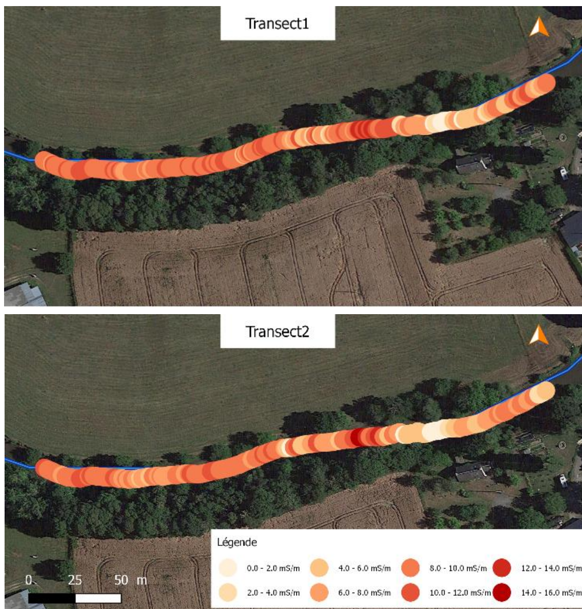
Figure 46 : Test de reproductibilité du protocole de mesure dans la rivière avec l'antenne CMD. Deux transects de mesure de la conductivité électrique du fond de la rivière ont été réalisés sur 300 m de cours d'eau à Signy le 7 juillet 2022 pour tester la variabilité des valeurs obtenues selon la justesse de l'observateur à effectuer les transects aux mêmes endroits de la rivière.
