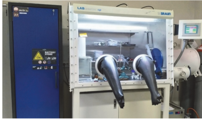
Figure 4.1 : Boîte à gants sous argon pour le démontage de cellules lithium-ion.
