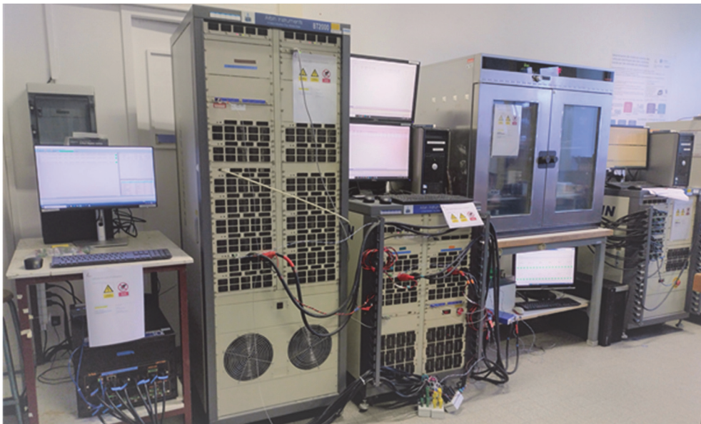
Figure 3.2 : Équipements des essais expérimentaux au laboratoire Ampère. De gauche à droite : banc ARBIN 16 voies, ARBIN 1 voie 500A, ARBIN 2 voies 200A, étuve Memmert et banc ARBIN 28 voies 2A.
