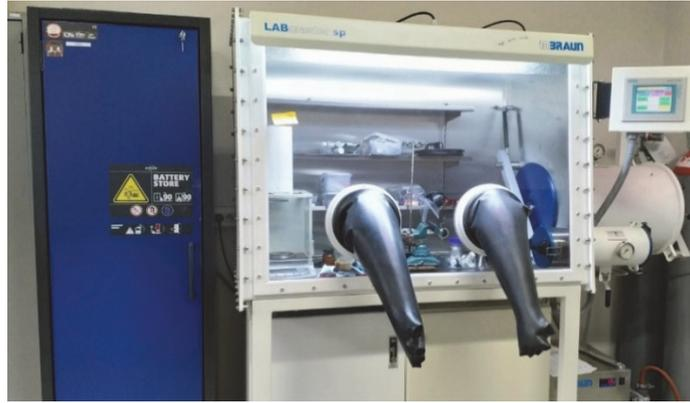
Figure 4.1 : Boite à gants sous argon pour le démontage de cellules lithium-ion.
