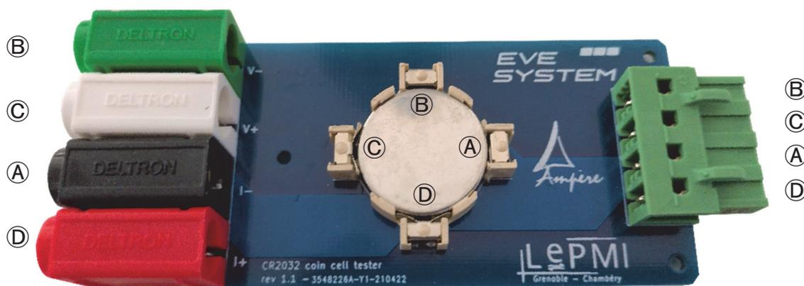
Figure 4.4 : Support de caractérisation pour pile bouton CR2032.
