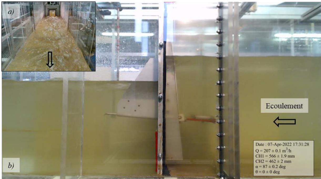
**Figure 4-39. Visualisation expérimentale d'un écoulement par-dessus le seuil incliné en (a) vue aval et (b) vue de profil, sous régime noyé pour un angle d'inclinaison fixé à 87° et un débit pompé de 207 m<sup>3</sup>.h<sup>-1</sup> (i.e. 57.5 L.s<sup>-1</sup>)**
