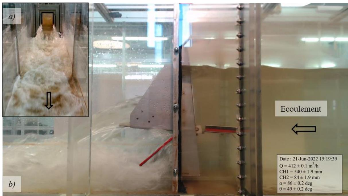
**Figure 4-68. Visualisation expérimentale d'un écoulement à travers la vanne fusible en (a) vue aval et (b) vue de profil, sous régime dénoyé pour un angle d'inclinaison fixé à  $86^\circ$  et un débit pompé de  $412 \text{ m}^3 \cdot \text{h}^{-1}$  (i.e.  $114.4 \text{ L} \cdot \text{s}^{-1}$ )**
