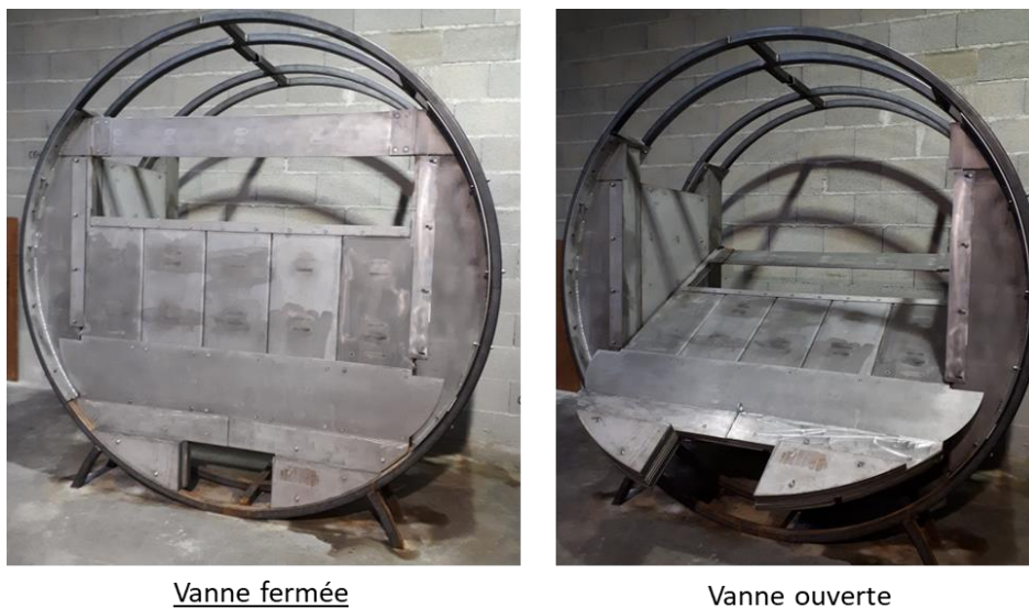
Figure 6-20. Vue générale de la vanne ouverte et fermée
