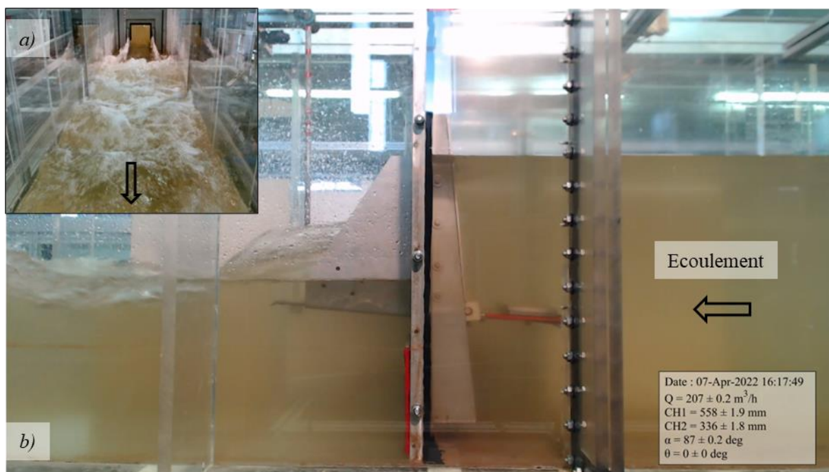
Figure 4-38. Visualisation expérimentale d'un écoulement par-dessus le seuil incliné en (a) vue aval et (b) vue de profil, sous régime partiellement noyé pour un angle d'inclinaison fixé à 87^\circ et un débit pompé de 207 \text{ m}^3 \cdot \text{h}^{-1} (i.e. 57.5 \text{ L} \cdot \text{s}^{-1} )
