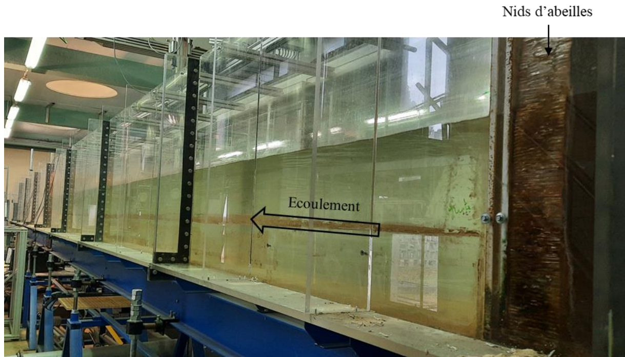
Figure 2-3. Photographie légendée du canal expérimental – Vue depuis l'amont
