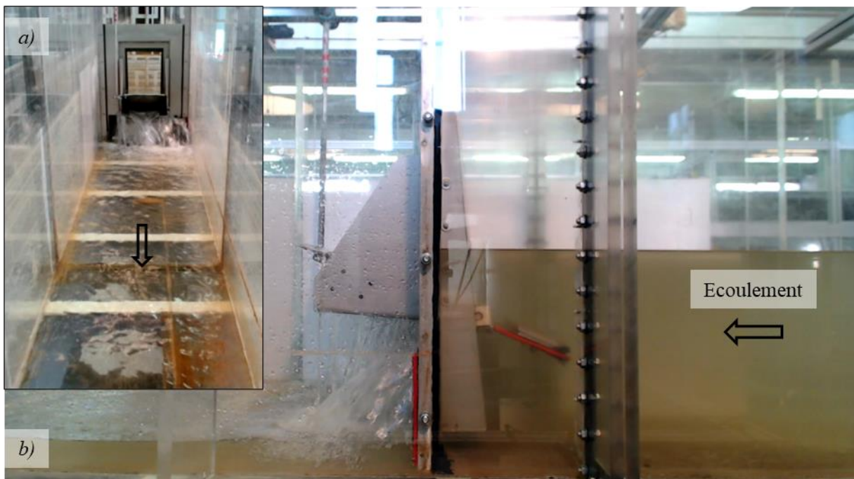
Figure 4-41. Mise en évidence des fuites au niveau de l'axe de rotation à travers l'exemple d'un écoulement de 10 \text{ m}^3 \cdot \text{h}^{-1} pour un angle d'inclinaison du volet de 67^\circ
