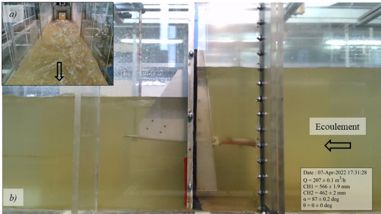
Figure 4-39. Visualisation expérimentale d'un écoulement par-dessus le seuil incliné en (a) vue aval et (b) vue de profil, sous régime noyé pour un angle d'inclinaison fixé à 87° et un débit pompé de 207 m 3 .h -1 (i.e. 57.5 L.s -1 )
