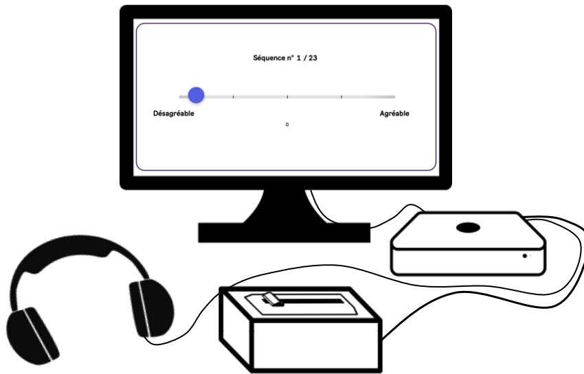
FIGURE 4.2 – Équipement et interface : le curseur à l'écran, présenté dans l'environnement Max MSP, est contrôlé par les déplacements du curseur sur le boîtier.
