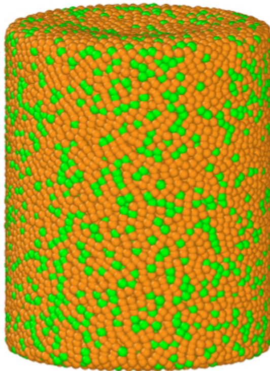
FIGURE 4.15 – Visualisation 3D de la pastille MOX après éjection. Les sphères vertes représentent les agglomérats de MP tandis que les sphères orange représentent les agglomérats d'UO 2 .
