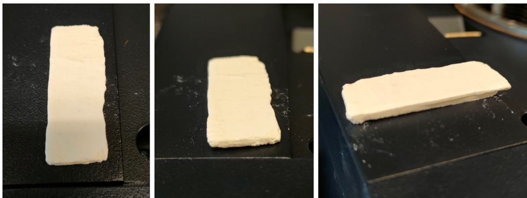
FIGURE VIII.1 – Images d'un nanocomposite (80/20) à base de RAN2500 montrant les irrégularités des dimensions des éprouvettes formées.
