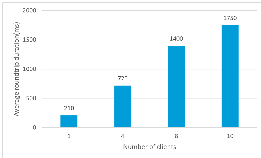
FIGURE 3.9 – Latence moyenne de l’aller-retour entre le client et le serveur SuccinctEdge pour un nombre de clients allant de 1 à 10
