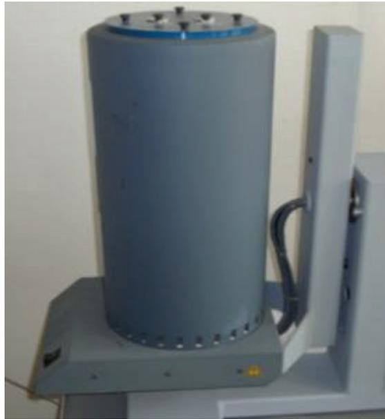
**Figure II.13:** Calorimètre Calvet C80 (Setaram) disponible à la plateforme d'analyses thermiques ([https://lmi.cnrs.fr/teams/plateforme\\_plat/](https://lmi.cnrs.fr/teams/plateforme_plat/)).
