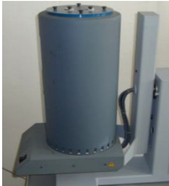
Figure II.13: Calorimètre Calvet C80 (Setaram) disponible à la plateforme d'analyses thermiques ( https://lmi.cnrs.fr/teams/plateforme_plat/ ).
