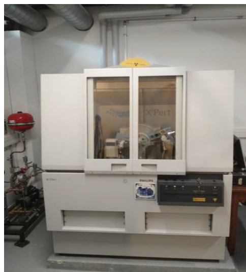
Figure II.8 : Diffractomètre poudre – PANalytical X'Pert Pro MPD disponible au laboratoire et principe de fonctionnement
