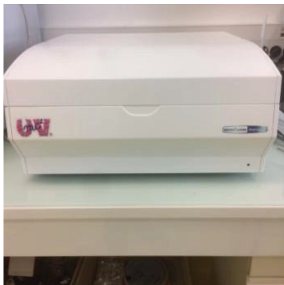
Figure II.11 : Spectrophotomètre UV-Visible de marque SAFAS disponible au laboratoire.
