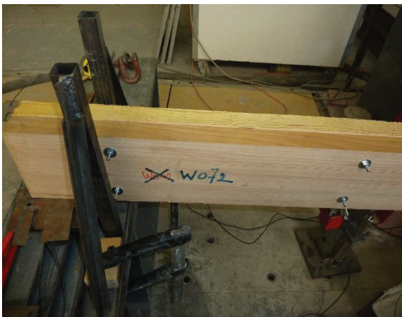
Figure A.9 : poutre bois Wo7 testée jusqu'à rupture, ruine par traction / cisaillement
