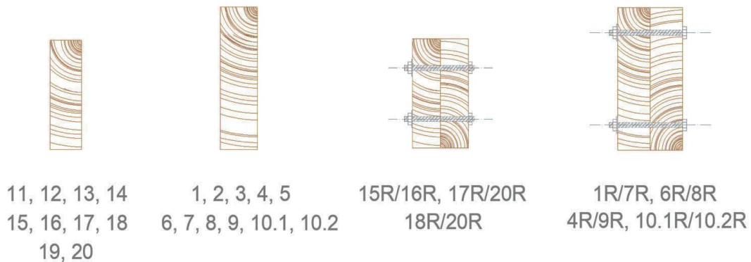
Figure II.20 : section des bois testée en flexion
