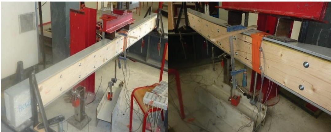
Figure II.72 : poutre HCW2.1 testée jusqu'à rupture
