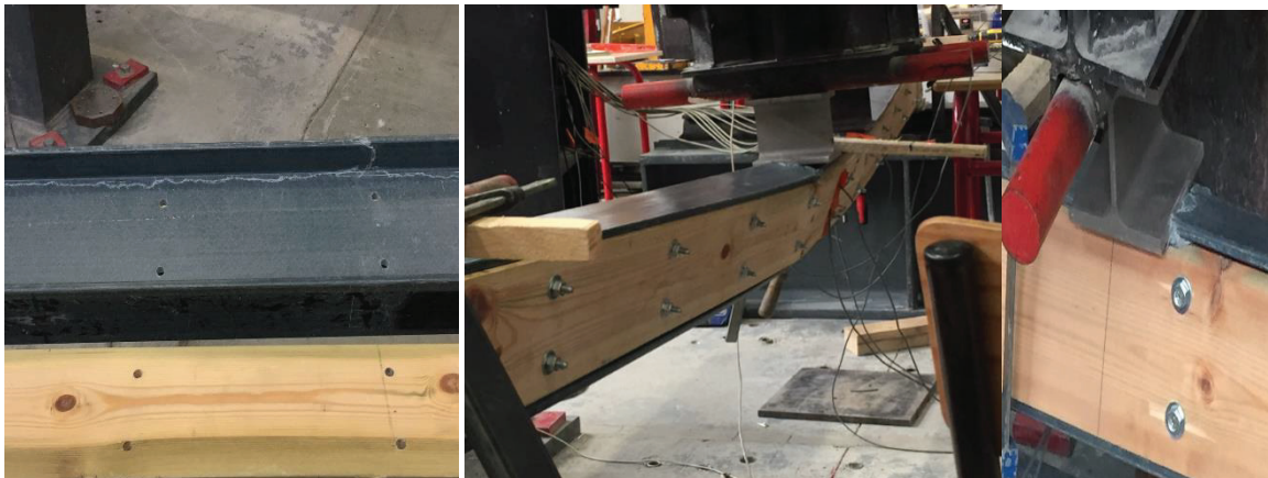
Figure A.6 : poutre HCW1.1 testée jusqu'à rupture
