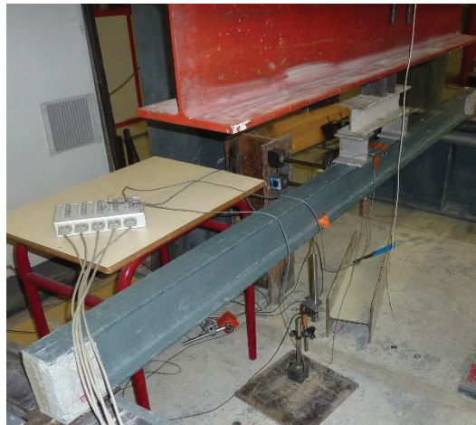
Figure II.14 : dispositif expérimental de flexion 4 points des poutres composites testées jusqu'à la ruine
