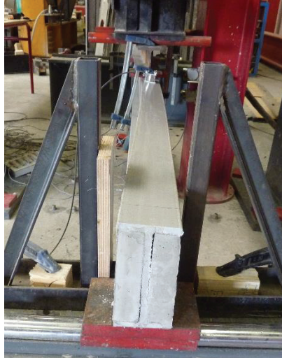
Figure II.19 : Ruine de la poutre Co10
