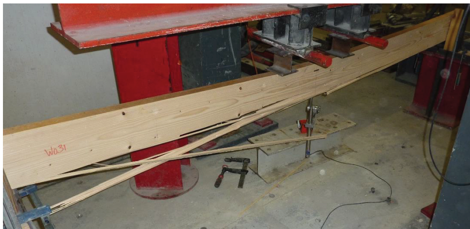
Figure A.14 : poutre 5 testée dans le domaine élastique en flexion 4 points
