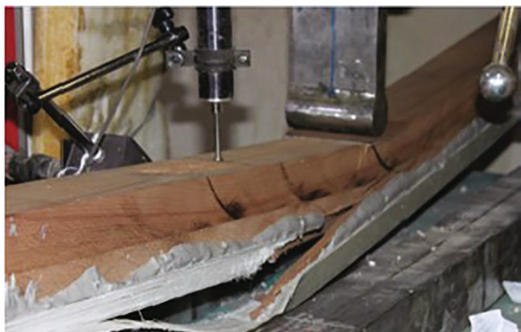
Figure I.31 : décollement du composite dans la poutre hybride [SHE 2020]
