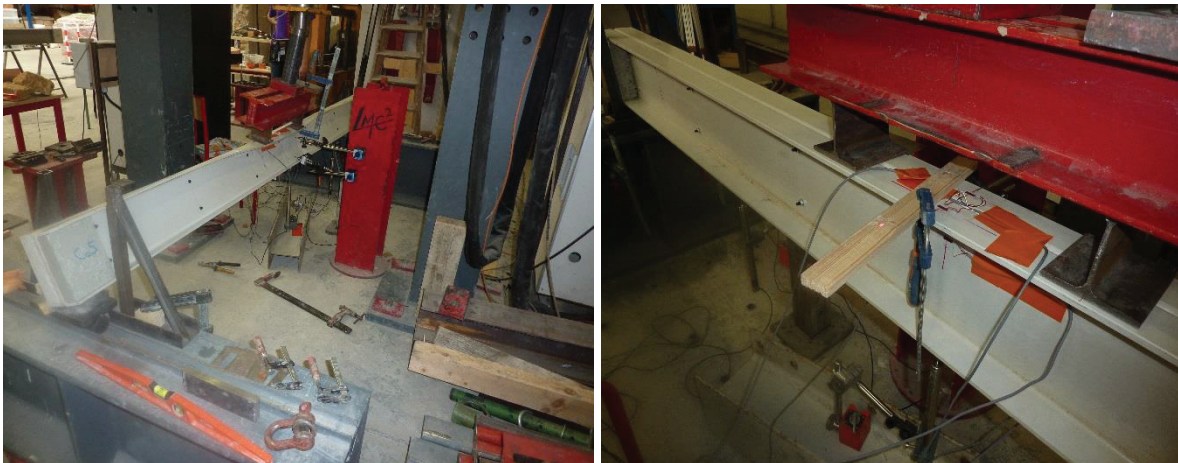
Figure A.11 : poutre composite Co5 testée jusqu'à rupture par déversement
