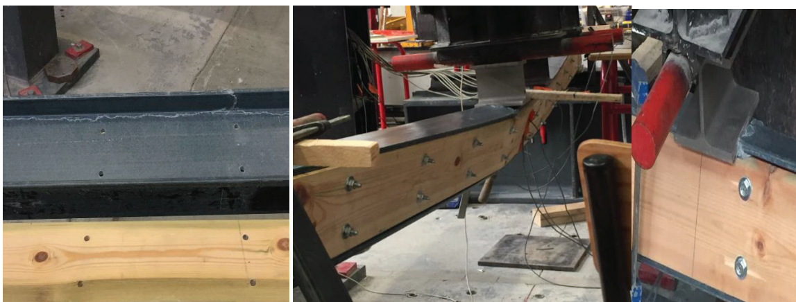
Figure A.6 : poutre HCW1.1 testée jusqu'à rupture
