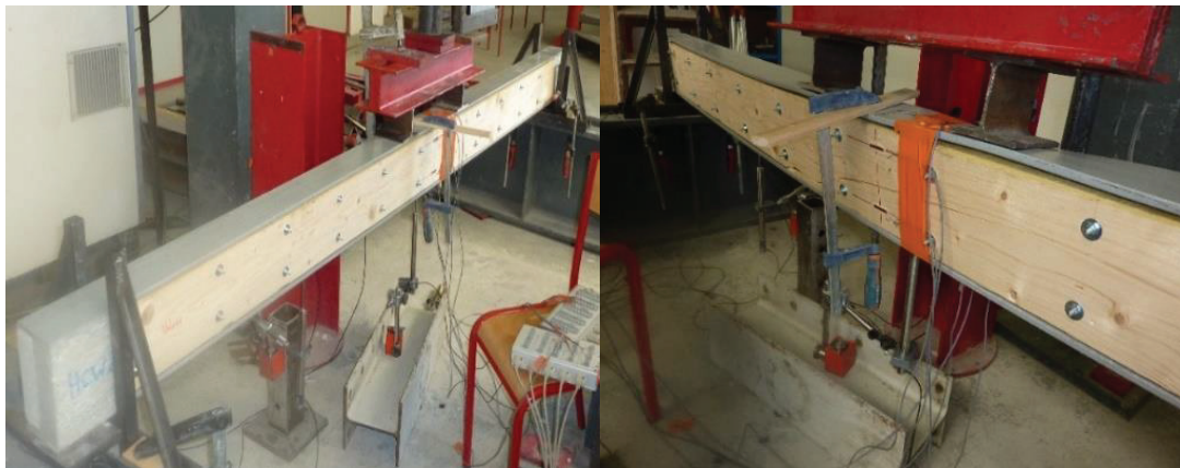
Figure II.72 : poutre HCW2.1 testée jusqu'à rupture
