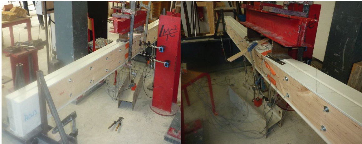
Figure II.83 : Essais à la ruine des poutres HCW3.1
