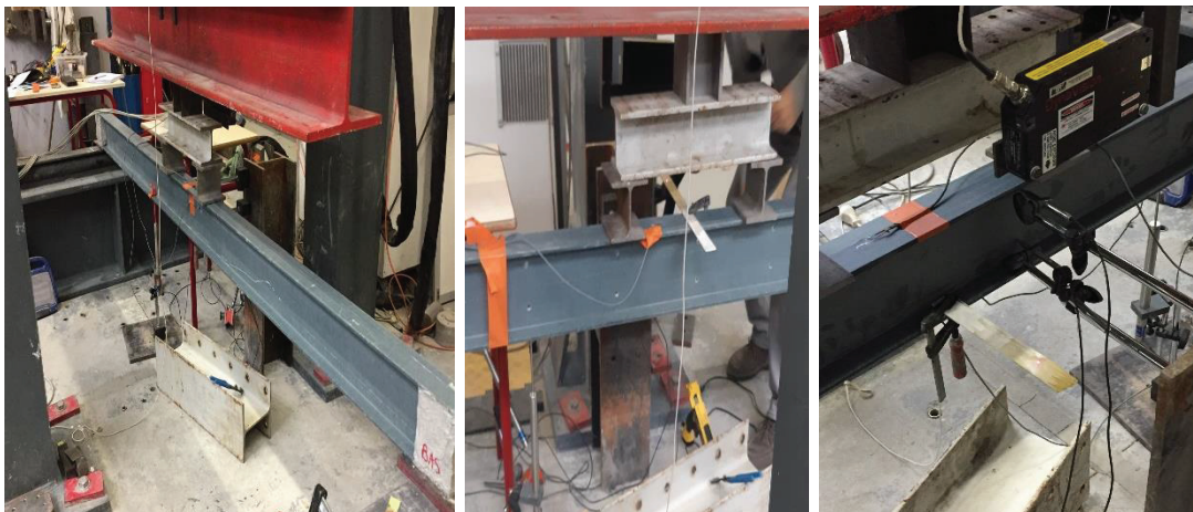
Figure A.5 : poutres Co1 et Co2
