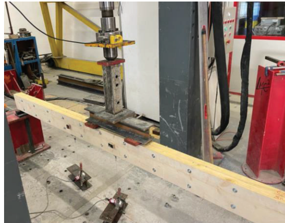
Figure II.31 : Dispositif expérimental de flexion de la poutre 6R/8R
