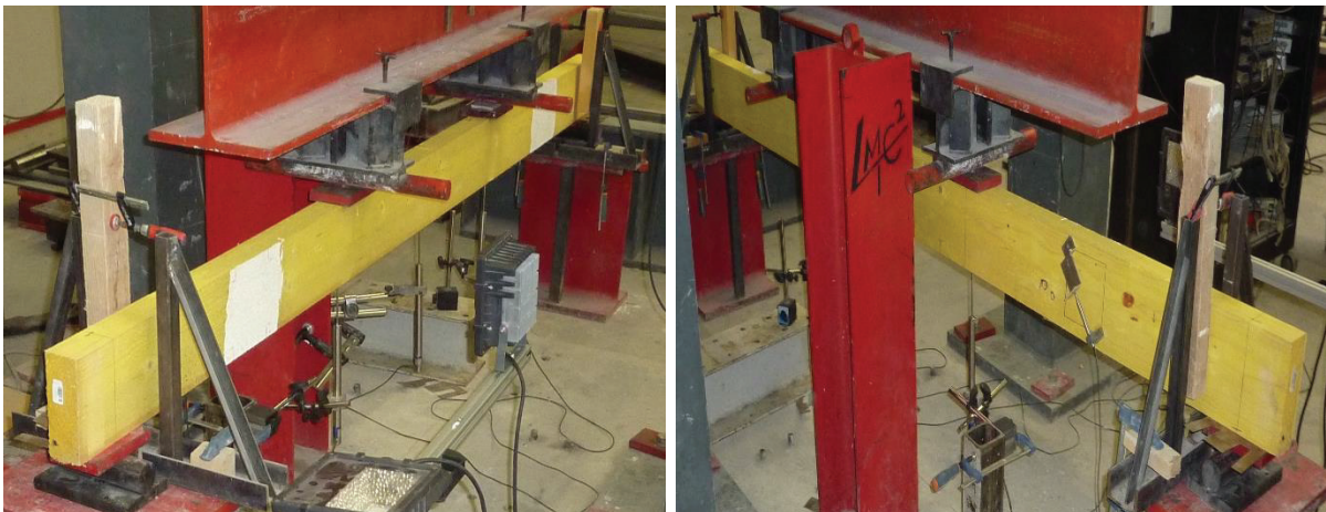
Figure A.14 : poutre 5 testée dans le domaine élastique en flexion 4 points
