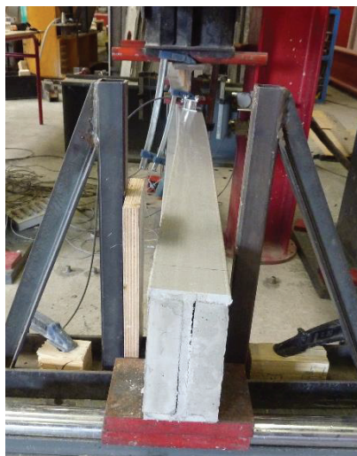
Figure II.19 : Ruine de la poutre Co10
