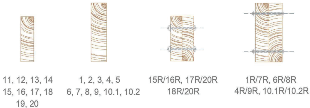
Figure II.20 : section des bois testée en flexion
