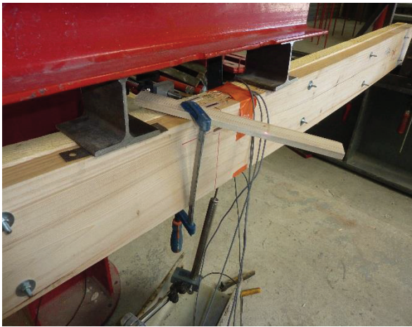
Figure A.8 : poutre bois Wo5 testée jusqu'à rupture, ruine par traction / cisaillement
