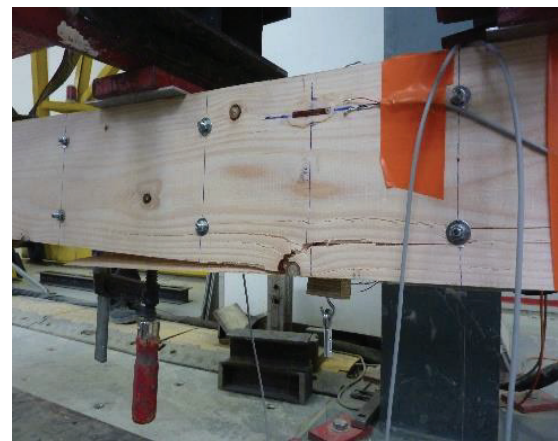
Ruine poutre 4R/9R
