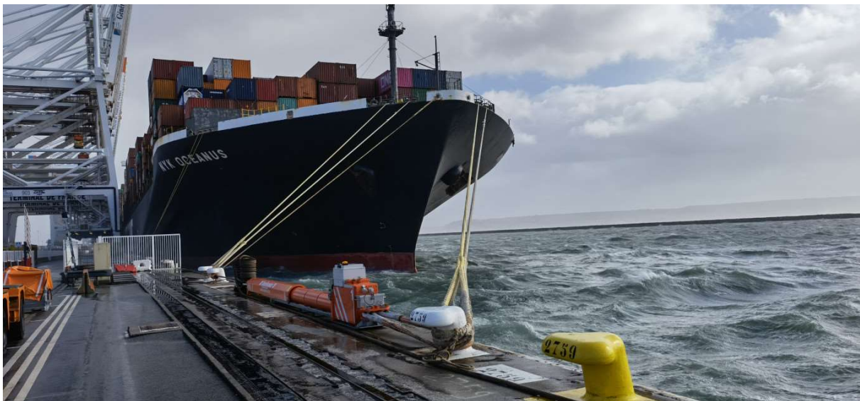
Photo 3. Navire amarré à Port 2000 avec le système ShoreTension©, port du Havre (Haropa), Seine-Maritime (Photo : Gazette Normandie)
