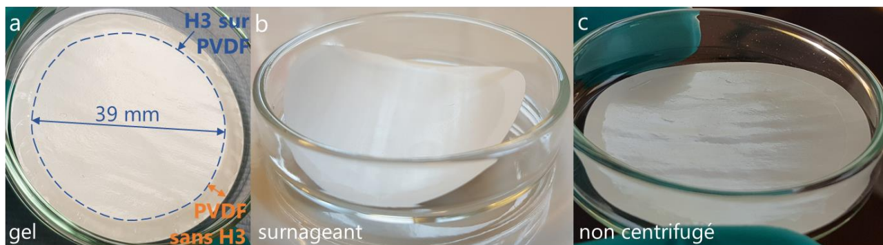
Figure 52 : Photos de membranes composites H3/PVDF fabriquées à partir de 7,0 mL de suspension colloïdale de H3 à 1,00 g/L issue : (a) de la phase gel, (b) de la phase surnageant, et (c) de la poudre exfoliée non centrifugée.
