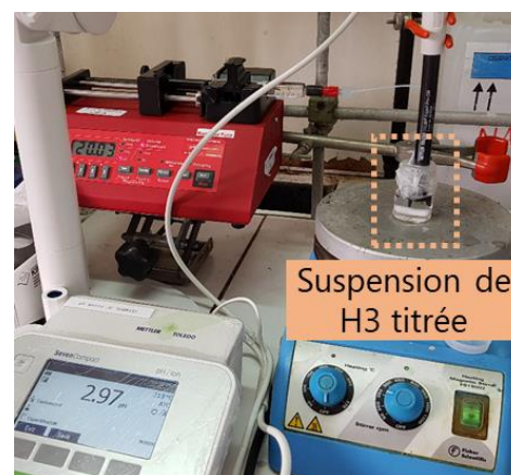
Figure A 22 : Photo du système de titrage de H_3Sb_3P_2O_{14} par les bases TEAOH ou TBAOH
