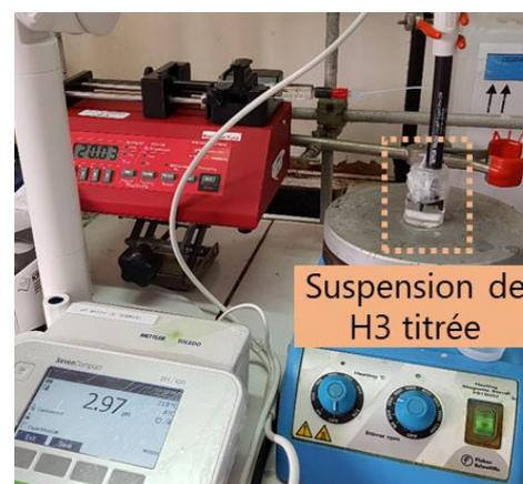
Figure A 22 : Photo du système de titrage de  $H_3Sb_3P_2O_{14}$  par les bases TEAOH ou TBAOH
