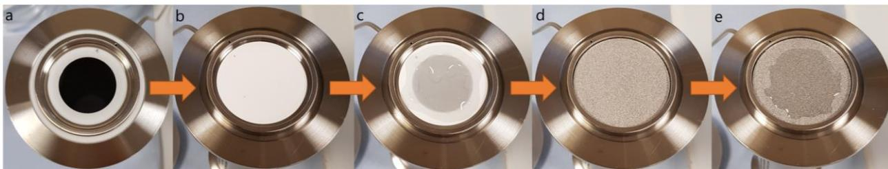
Figure A 27 : Photos du processus d'installation et de mouillage de la membrane ( $H_{2,7}Na_{0,3}/PVDF$ ), représentant les différentes étapes proposées (a-e) par une vue du dessous de la partie basse de la cellule Sterlitech.
