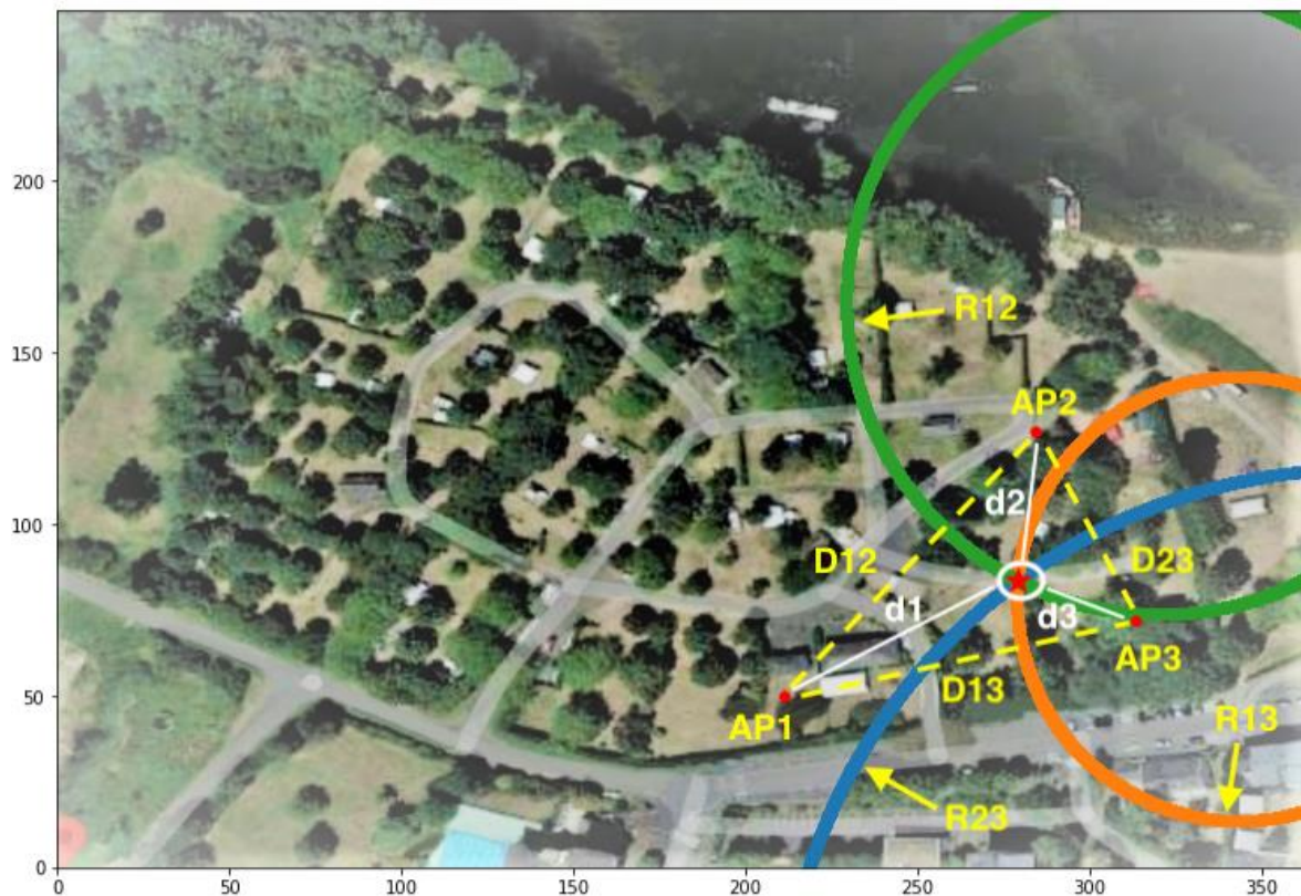
Figure 26 Les cercles d'Apollonius (vert, bleu, orange) pour les AP1, AP2, AP3, séparés par les distances D_{12} , D_{13} , D_{23} . Un client situé à l'intérieur du cercle blanc se trouve à des distances d_1 , d_2 , d_3 des trois AP. Les rayons des cercles sont R_{12} , R_{13} , R_{23} . La solution pour la localisation du client déterminée à partir des valeurs de RSS aux trois AP est indiquée par l'étoile rouge à l'intersection des cercles.
