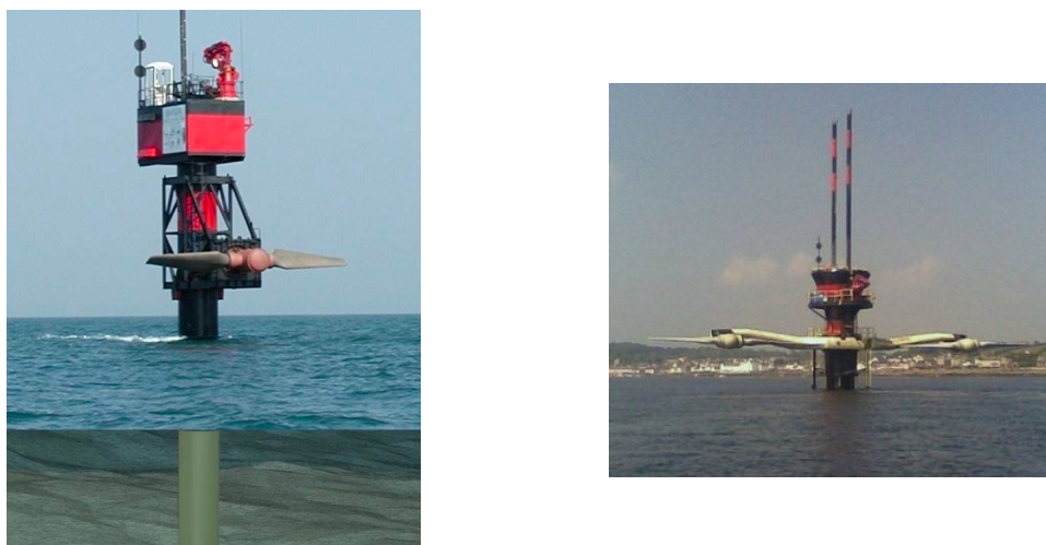
FIGURE 1.2 – Images des rotors Seaflow à gauche et Seagen à droite en position haute pour maintenance © MCT
